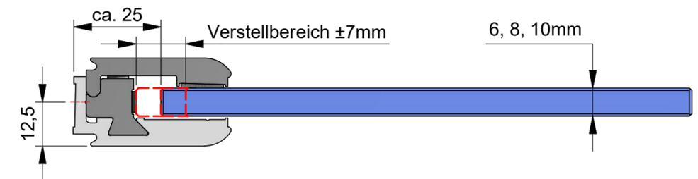
Die Schrauben der Klemmbacken sollten mit einem max. Drehmoment von **nicht mehr als 10N·m** angezogen werden. Nach ca. 15 Minuten ziehen Sie bitte die Schrauben noch einmal auf das maximale Drehmoment nach.
