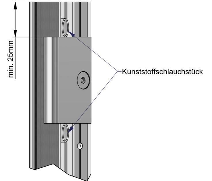
Bei Verwendung von Sicherungsstiften ist die Position des Glases durch die Glasbearbeitung definiert. Achten Sie aber bitte darauf, daß das Glas so positioniert wird, daß die Sicherungsstifte mittig in der Glasbearbeitung sitzen.
